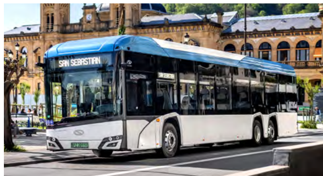
Urbino 15 LE electric na ulicach San Sebastian. 15-metrowy model niskowejściowy oferowany jest w wersjach klasy 1 i 2.
