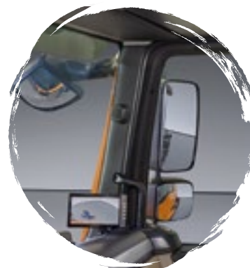
Asystent skrętu (VTA) MAN Dzięki systemowi kamer bocznych kierowca może łatwo wykryć osoby w martwym polu widzenia
